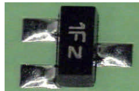
Bei der Reflowlötung von SOT-23 Bauelementen führten Lötflächen-Abrundungen allerdings zu keinem deutlich besseren Ergebnis
