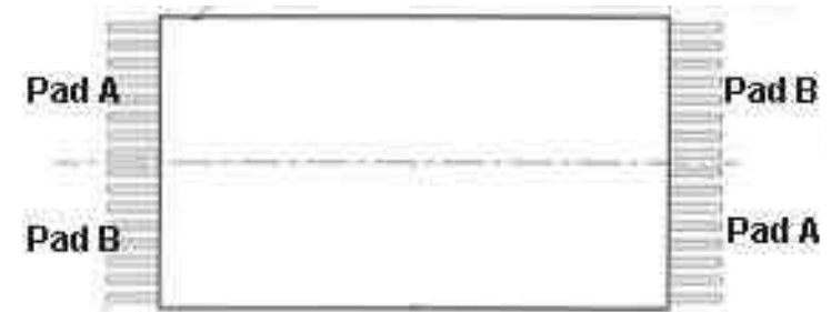
Anordnung von zwei unterschiedlichen Lötflächen an einem TSOP 8 x 16 Bauteil
